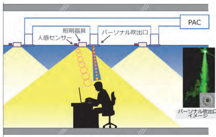
空調と照明のパーソナル化
