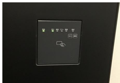
非接触ICカードリーダー (貸室扉)
