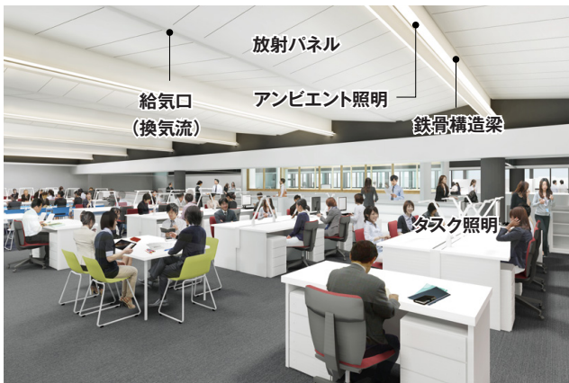
限られた階高において、優れた屋内環境を実現する統合環境装置
