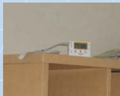
温湿度測定器 : 主要居室 (1住戸5カ所程度)に設置 隅角部や窓際にならないように、 居住者とともに設置
