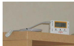
温湿度測定器 温度と相対湿度を30分間隔で測定。主要居室に設置する。
