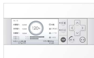
省エネナビ 太陽光発電の発電量やエネルギー使用量をモニター・WEBで見られる。
