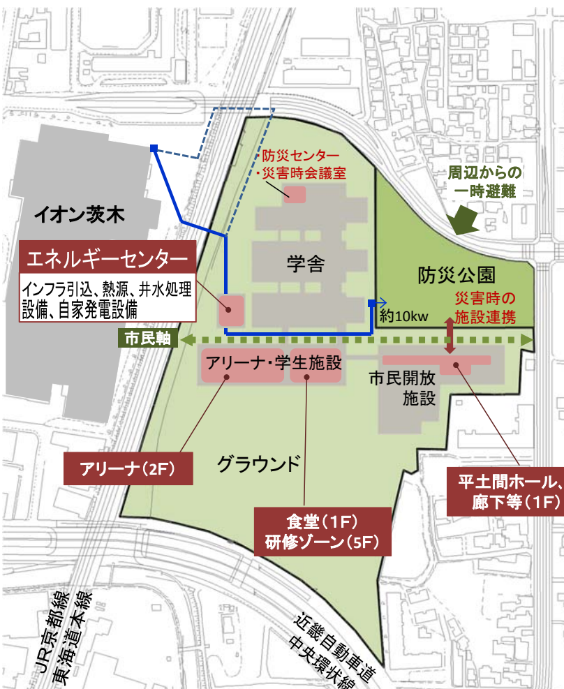
○各非常用発電機(大学、イオンの発電容量及び非常時の防災公園への供給電力量割合
