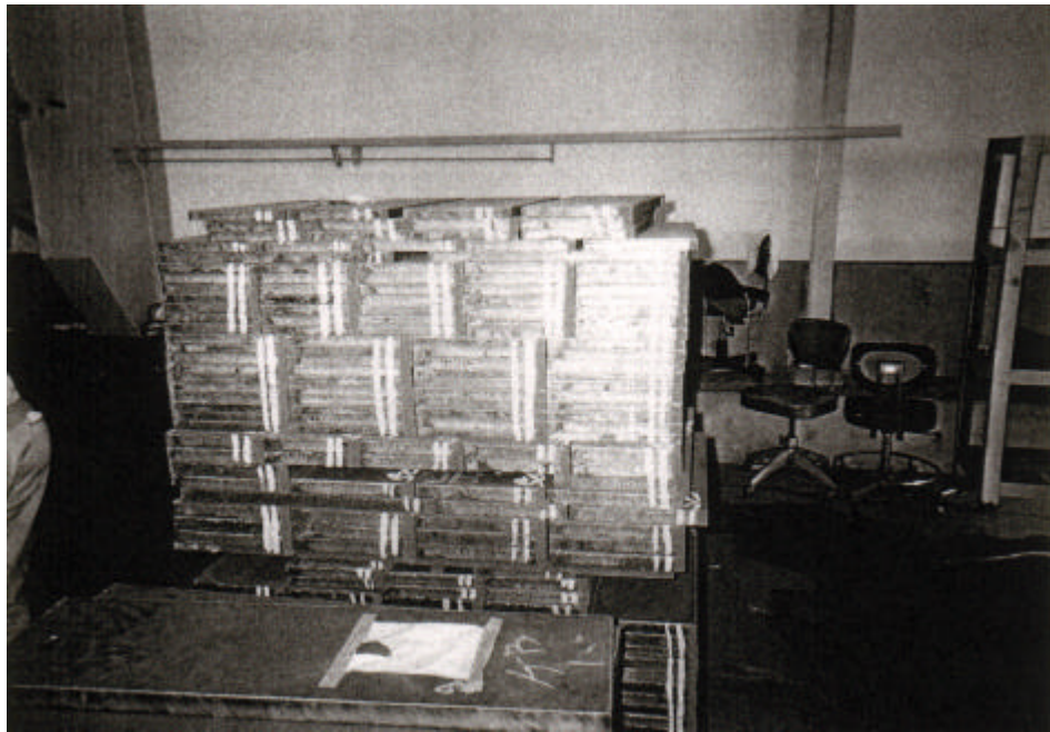
(写真1) シャーリング工場から受け入れた切板 きちんと整理されて保管されている。材料種別を示すペンキも鮮明。
