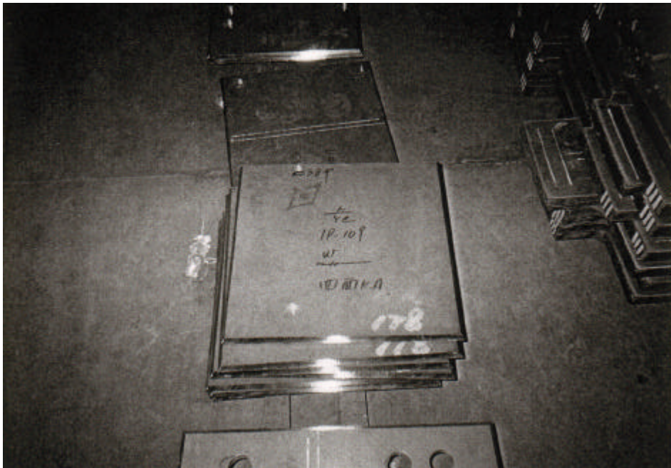
(写真6) 開先加工された切板
