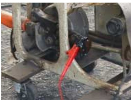
写真 3.5.3 U型溝加工した集電ブラシによる電圧計測端子のフィードローラへの取り付け状況および溝加工部のクローズアップ
