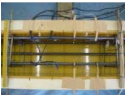
写真 3 RC はり試験体センサー類設置と保管状況
