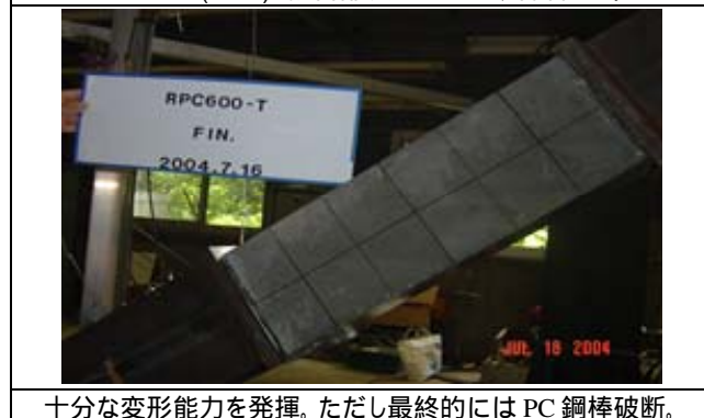
HPFRCC(RPC): 接合部長さ 400mm、付着なし。
