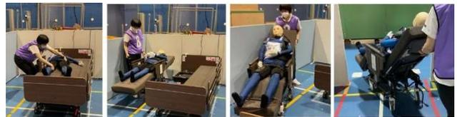
図7 離床支援ロボットによる介助避難実験の様子
