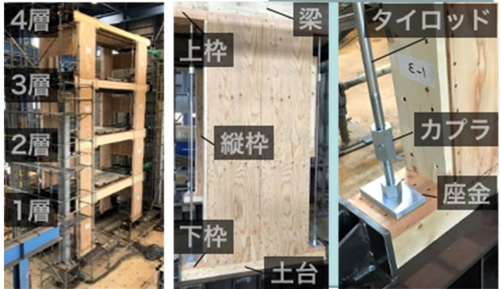
試験体の様子（1層から4層の仕様の概要は下表に示す）
