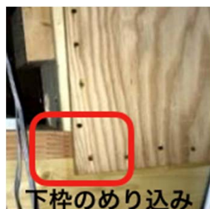
実験後（1/18rad時）の特徴的な破壊の様子
