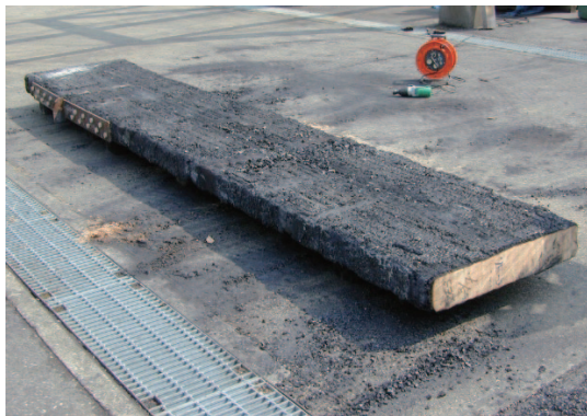
図1 火災加熱を受けた大断面集成材の梁
