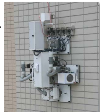
予防保全総プロにて製作した外壁診断装置 (国総研)
