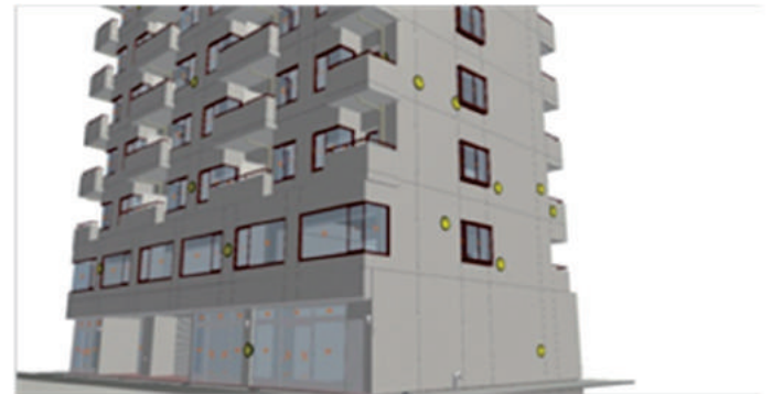
図10 パースによる修繕マーカーの表示状況
