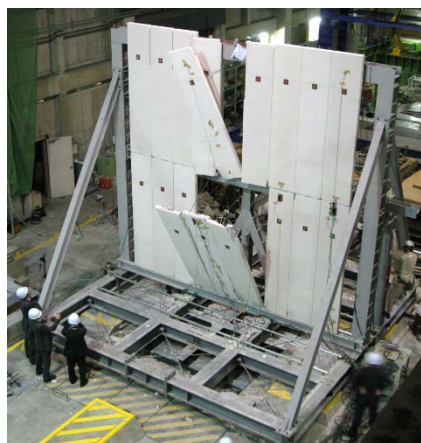
写真1 試験体No.1のパネル脱落状況(加振[5]) (落下防止ワイヤーにぶら下がって傾いた状態)
