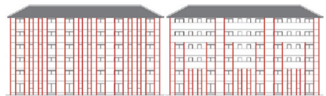
(1) 耐力壁両側に金物設置 (2) 開口係数適用時の金物配置
