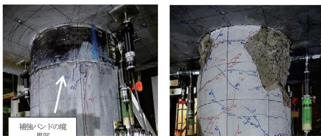
写真IV-5 試験体 PHC, RC 杭頭部写真
