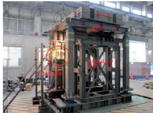
写真IV-4 振動台実験の加振装置全景
