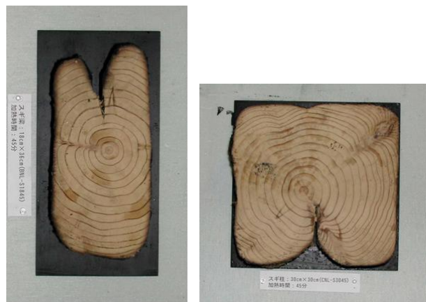
スギ梁 18cm×36cm 45分加熱(背割り入り) スギ柱 30cm×30cm 45分加熱(背割り入り)
