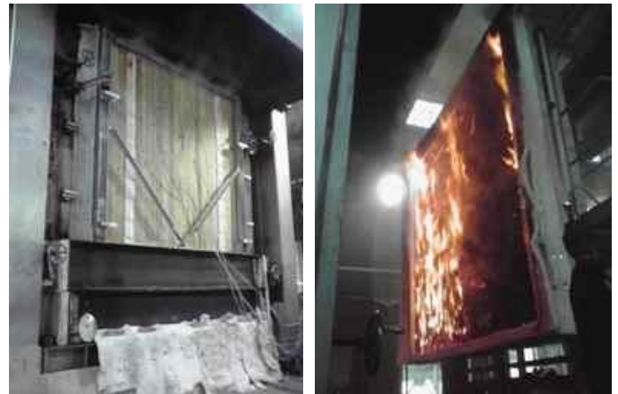
図 7 CLT 壁パネルの載荷加熱実験中と加熱終了後の様子
