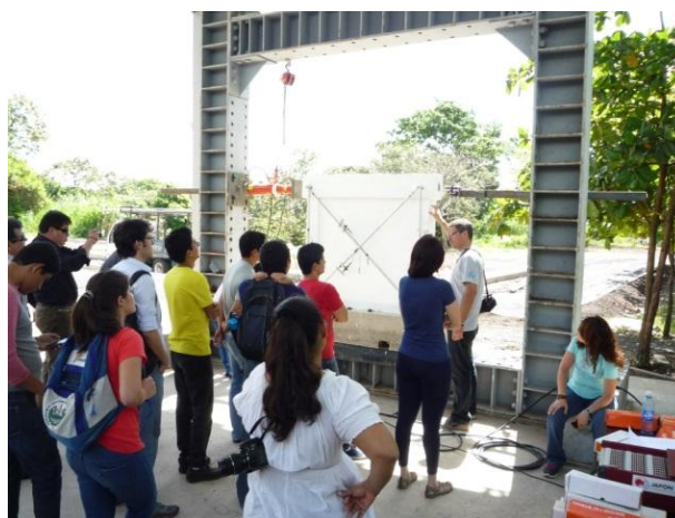
写真5 コンクリートブロックを用いた枠組積造壁試験体の加力準備(UES 実験棟)
