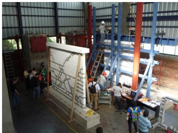
写真3 コンクリートブロックを用いた枠組積造実大壁試験体(右側の白い部分)の加力準備(UCA 実験棟)
