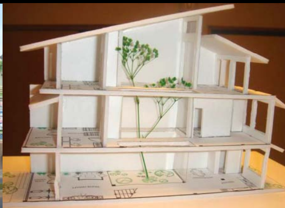
中庭、裏庭を取り、通風採光を考慮したチューブハウスの改善提案住宅
