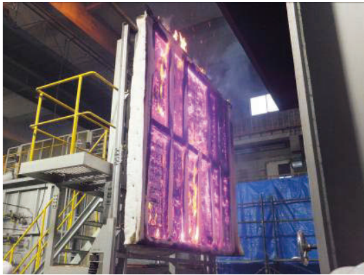
写真1 加熱試験直後のCLTパネル
