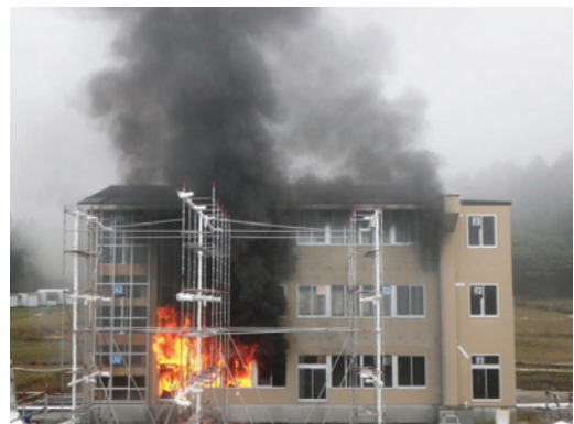
写真6 出火室フラッシュオーバー (68分後)
