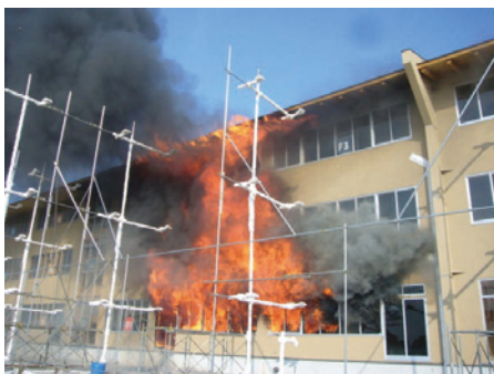
写真2 噴出火炎による上階延焼 (6分後)
