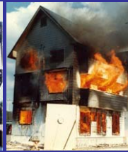
3階建て枠組壁工法建物の加力試験と火災実験
