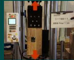
引きボルト接合部の引張り試験
