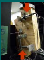
CLTの面内せん断試験
