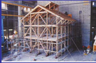
大断面木造の静的加力試験
