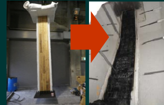
CLTの座屈試験
