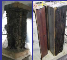
燃え止まり部材の耐火試験
