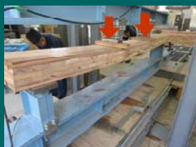
CLTの曲げ試験
