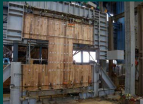
実大CLT壁パネルの面内せん断試験
