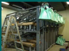
CLTの長期荷重載荷試験
