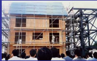
3階建て枠組壁工法建物の加力試験と火災実験
