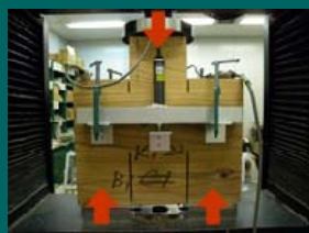
CLTの面内せん断試験
