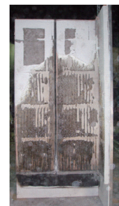
図8 Case2（外断熱） （実験後のEPS）
