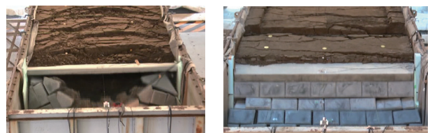
空積み（谷積み仕様） （入力最大加速度 1000gal）
