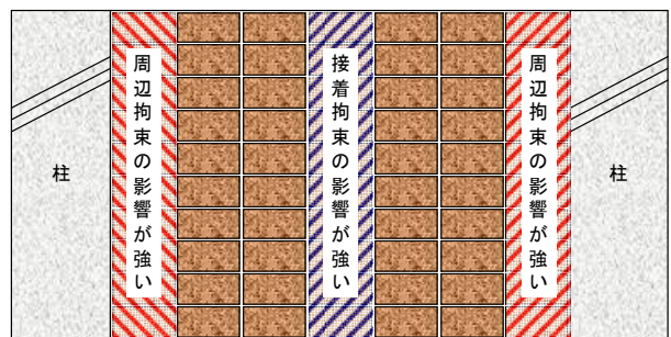
図 5 柱から周辺拘束を受けるタイル張り仕上げ試験体
