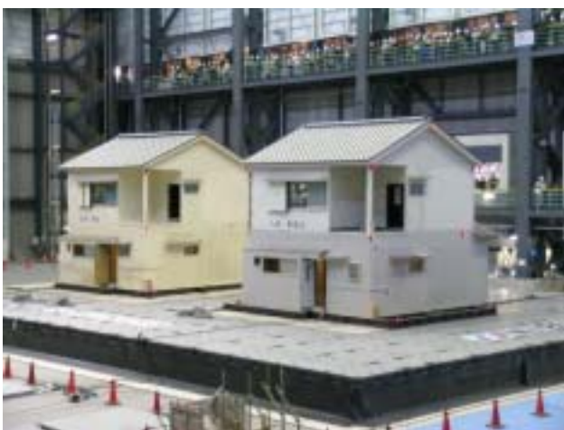
写真2 加振前の試験体(右が無補強のA棟)
