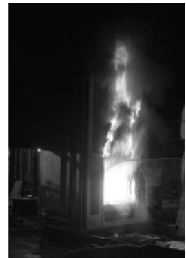
図 6 ファサード試験の状況
