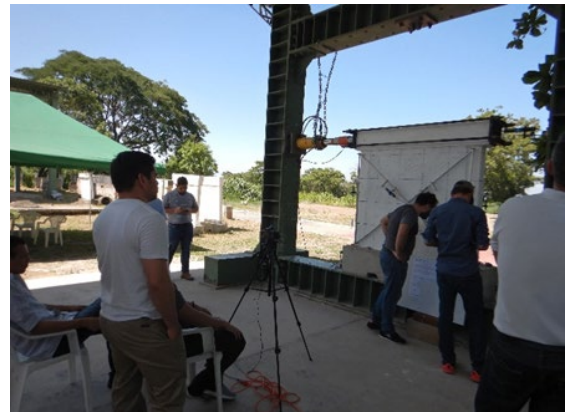
写真-I-2. 1. 5 枠組組積造壁の水平載荷実験の様子
