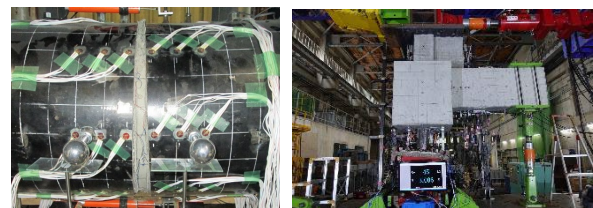
図2 杭頭部および部分架構の構造実験
