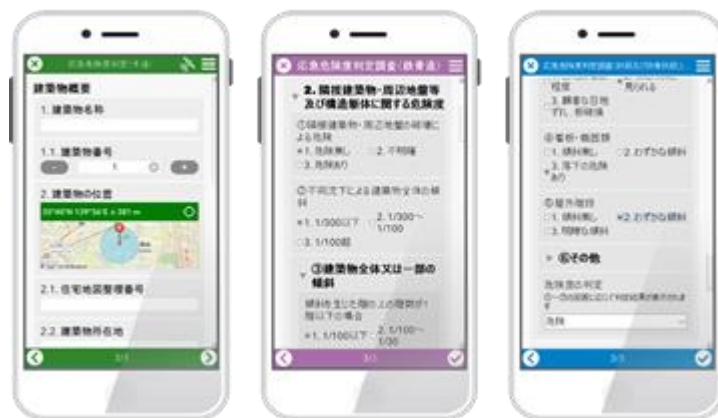
図-I-1. 2. 14 クラウド GIS をベースとした応急危険度判定支援ツールの画面イメージ
