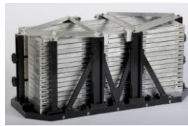
せん断土槽により様々な態様（深さ・地下水位）の宅地を再現
