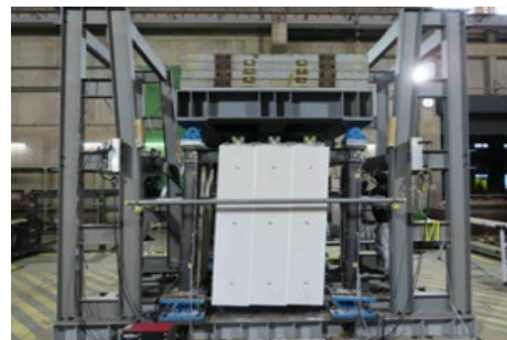
写真2 非構造部材付フレームの実験
