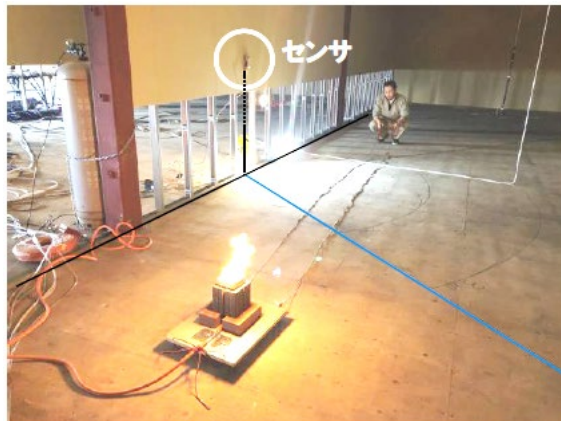
図5 市販の人感センサによる炎の感知実験
