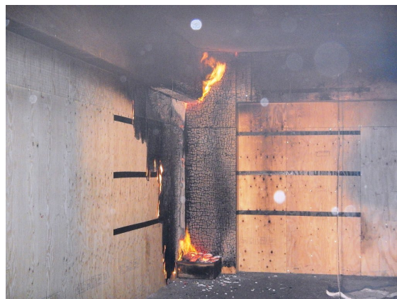
図1 天井を不燃化して壁を木材で仕上げた区画の火災実験の燃え止まりの例(既往実験)
