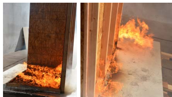
(a) OSB ボードへの着火と燃え抜け
