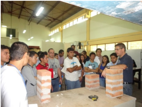
写真1 組積造試験体の加力準備 (UES 実験棟)
