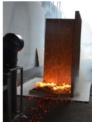
図3 火の粉による着床・着火に関する実験
