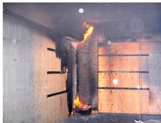
図3 天井を不燃化した火災実験における木質内装の燃え止まりの例
