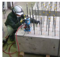
写真1 穿孔方法の比較試験による付着強度の比較試験
