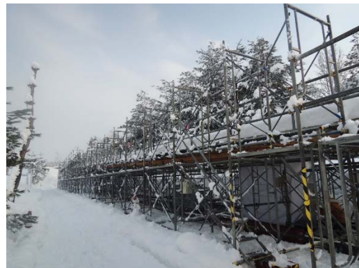
図 2 屋外実験での試験体の概観(流れ方向長さ 50m)
