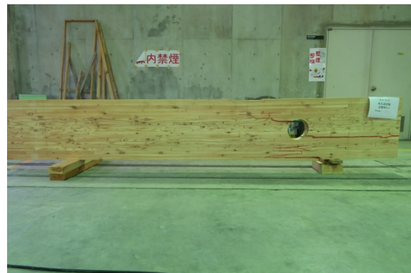
写真 2 破壊性状の例
