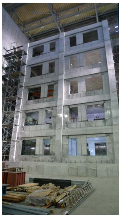
写真3 実大5層壁付き架構加力実験
