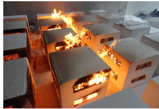
写真1 実験時の延焼状況
