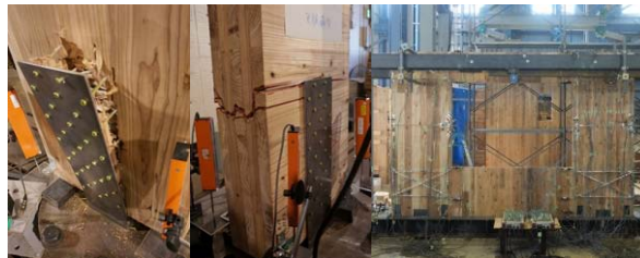
図2 接合部の試験(左)と構面の試験(右)の様子
