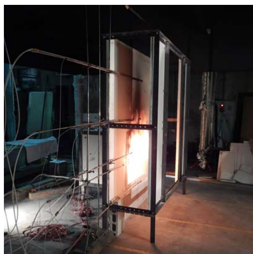
図2 ダブルスキンにおける噴出火炎性状に関する模型実験
