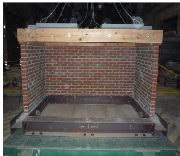
写真1 床付き壁試験体(全加振終了後)
