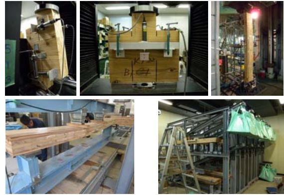
図2 CLT の材料性能の評価試験の様子 (解説) 左上：ツーレルシェアによるせん断試験、 中央上：LW 改良法によるせん断試験、 右上：座屈試験、左下：曲げ試験、 右下：長期荷重載荷試験
