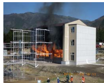
図 5 木造 3 階建て学校の実大火災実験(準備実験)の様子
