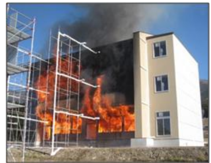
図 5 実大規模での耐火性能等を確認した様子
