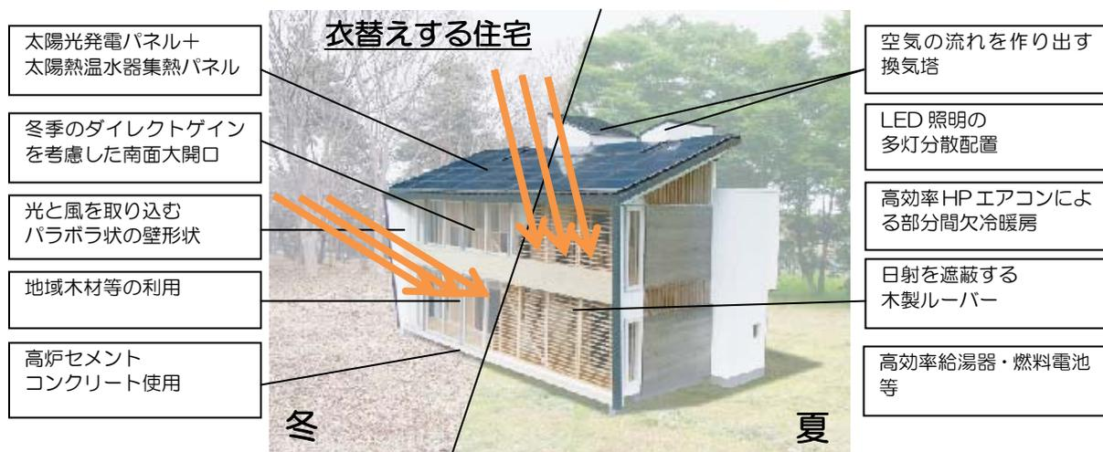
図-3 LCCM住宅デモンストレーション棟のイメージ
