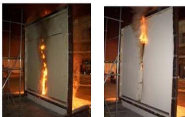
図3 アルミ製間仕切り壁の加熱実験
