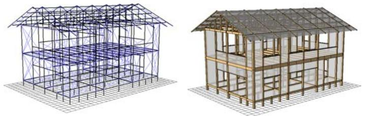
図5 伝統的木造住宅の震動台実験の解析
