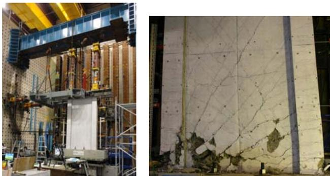
写真1 耐力壁の構造実験
