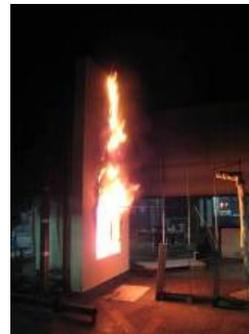
図8 外断熱工法試験体の燃焼性状
