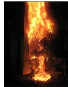
図9 EPS試験体の燃焼性状
