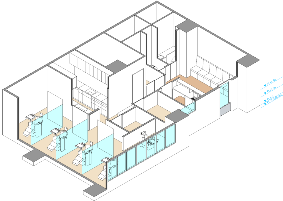
図IV-32 アイソメ図（小規模診療所モデル・浸水対策案1） ※内部がわかるように壁の一部を削除した
