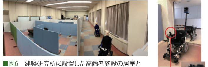
■図6 建築研究所に設置した高齢者施設の居室と廊下を模擬したセット
