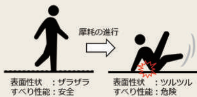
図1 摩擦によるすべりの変化のイメージ
