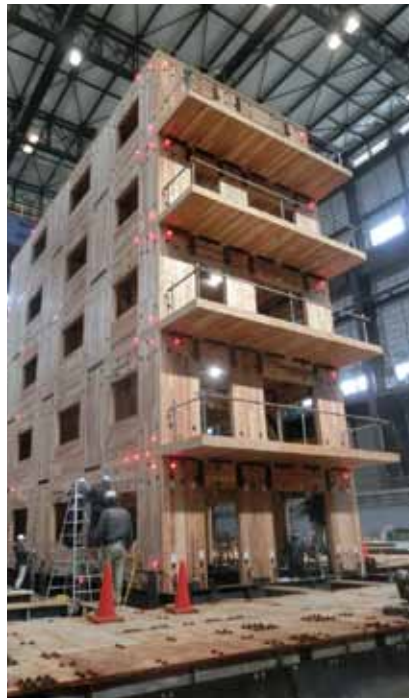
写真7 実大5階建て振動台実験
