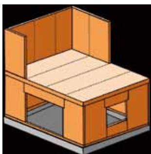
図2 一般化されたCLTパネル工法の概要
