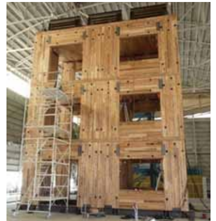
写真4 実大3階建て振動台実験
