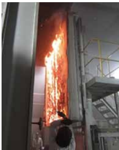
写真14 CLTの壁（左）、床・屋根（右）の防耐火性能を検証する実験の終了直後の試験体
