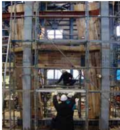
写真3 CLTパネル工法の要素実験
