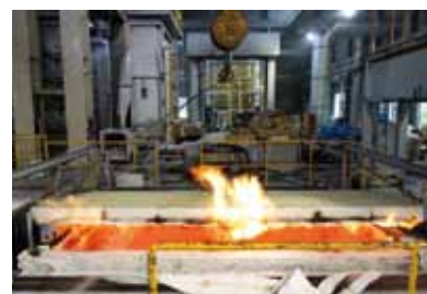
写真14 CLTの壁（左）、床・屋根（右）の防耐火性能を検証する実験の終了直後の試験体
