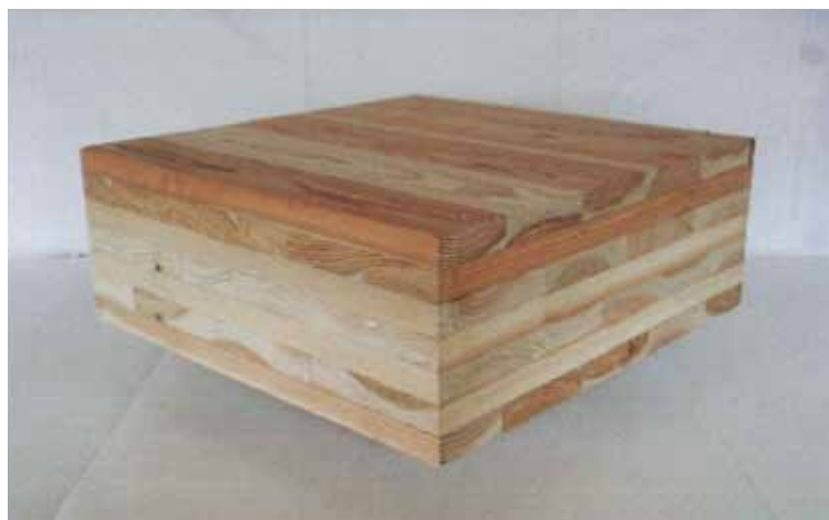
写真2 新しい材料～クロス・ラミネイティド・ティンバー(CLT)
