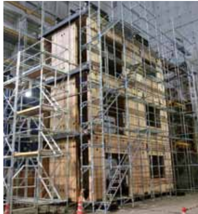
写真5 静的加力試験
