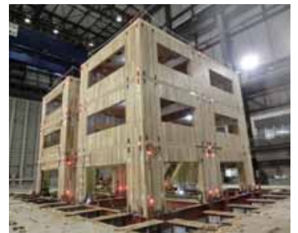
写真8 低層住宅用CLTパネル工法の振動台実験
