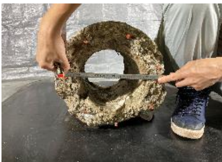
e) PC 鋼材の配置半径
