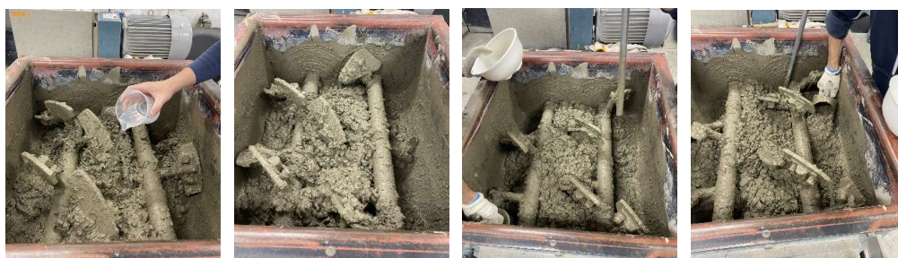
(a) NaCl 溶液の添加 (b) 30秒間練混ぜ (c) 試料採取① (d) 試料採取②
