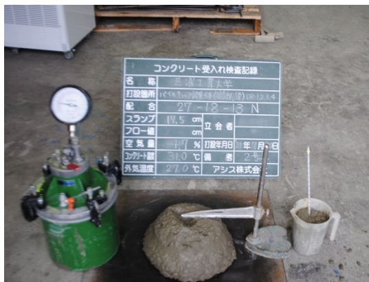
写真 3.2.1-1 パイルキャップ、基礎梁 コンクリート受入れ調査記録 (打設日 2021 年 7 月 30 日)
