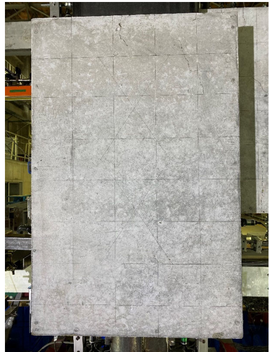
図・写真 3.1.3-15 試験体 D-4 ひび割れ状況 (2Cycle)
