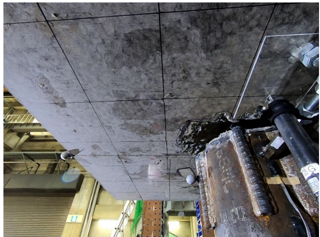
図・写真 3.2.3-39 試験体 DR-3 ひび割れ状況 (7Cycle)
