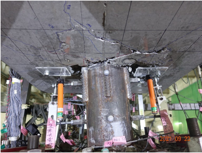
写真・図 3.2.3-1 試験体 DR-1 最終破壊状況及び Q-R 関係
