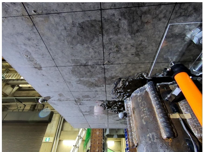
図・写真 3.2.3-40 試験体 DR-3 ひび割れ状況 (8Cycle)
