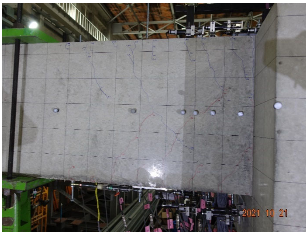
図・写真 3.2.3-63 試験体 DR-5 ひび割れ状況 (10Cycle)
