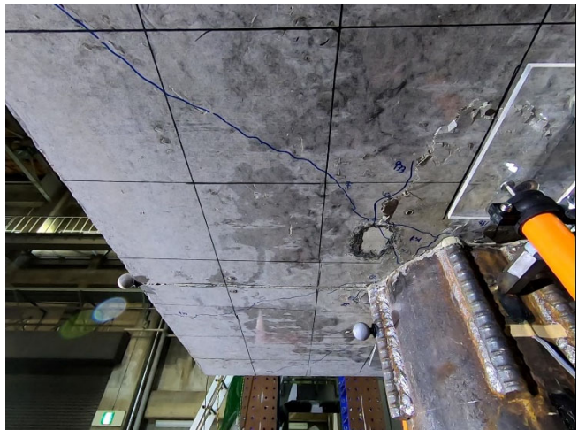
図・写真 3.2.3-16 試験体 DR-1 ひび割れ状況 (6Cycle)
