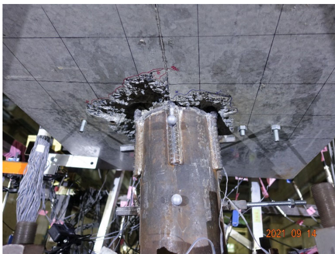
写真・図 3.2.3-2 試験体 DR-2 最終破壊状況及び Q-R 関係
