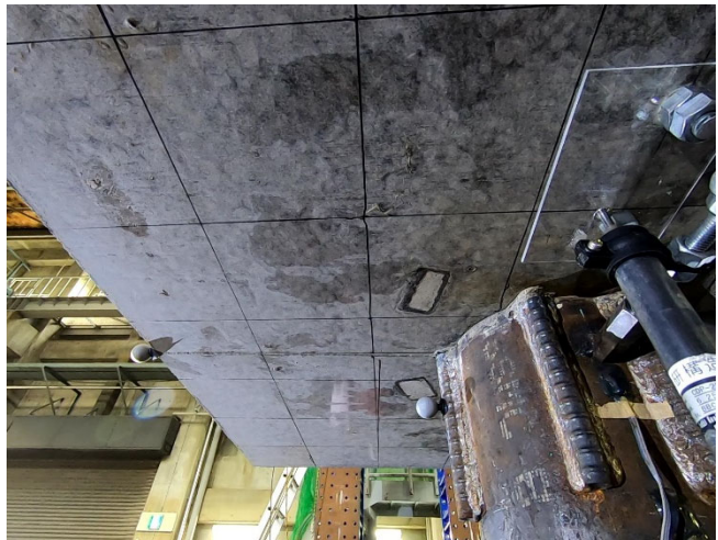
図・写真 3. 2. 3-33 試験体 DR-3 ひび割れ状況 (1Cycle)
