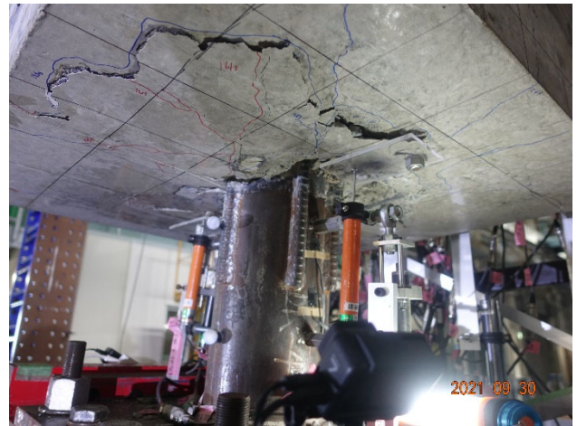
写真・図 3. 2. 3-4 DR-4 最終破壊形態および Q-R 関係
