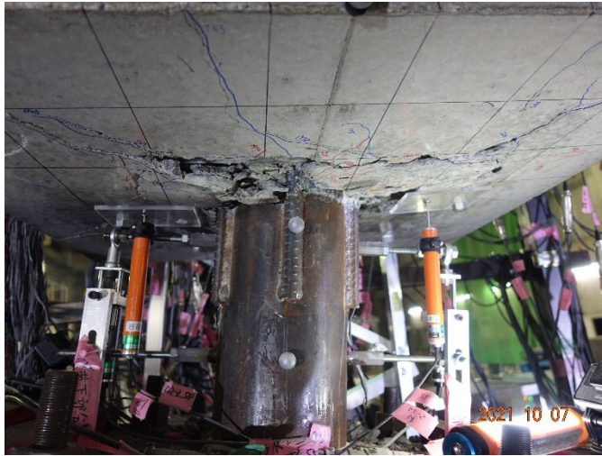
写真・図 3.2.3-1 試験体 DR-1 最終破壊状況及び Q-R 関係
