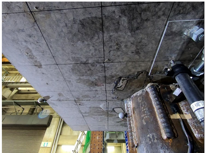
図・写真 3. 2. 3-38 試験体 DR-3 ひび割れ状況 (6Cycle)
