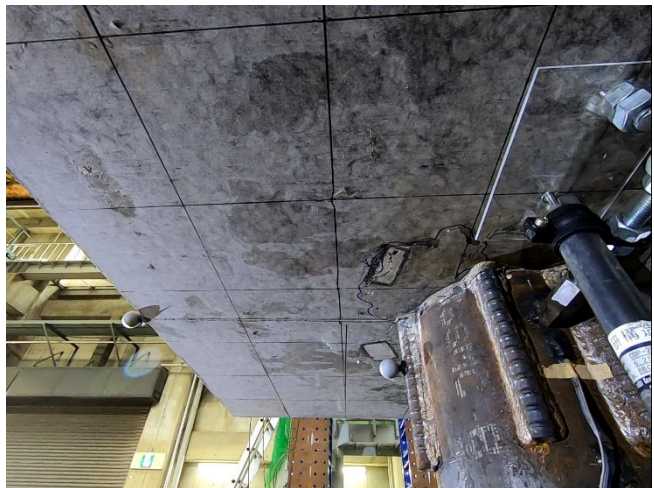
図・写真 3. 2. 3-37 試験体 DR-3 ひび割れ状況 (5Cycle)
