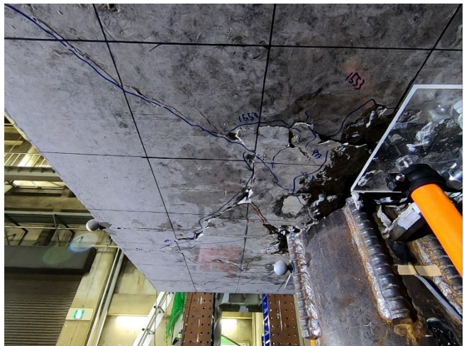
図・写真 3.2.3-19 試験体 DR-1 ひび割れ状況 (9Cycle)
