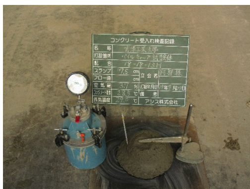
写真 3.1.2-1 試験体 D-3 コンクリート受入れ調査記録 (打設日 2019 年 9 月 27 日)
