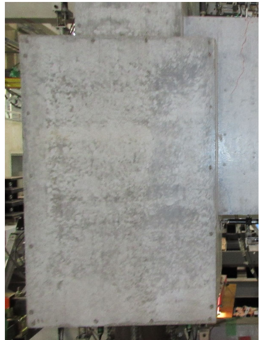
図・写真 3.1.3-3 試験体 D-3 ひび割れ状況 (1Cycle)
