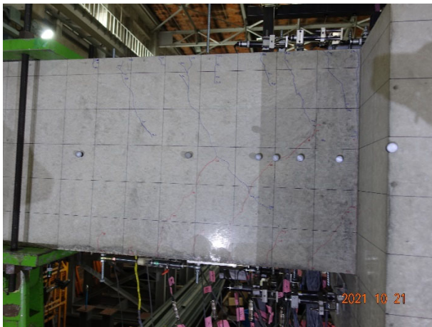
図, 写真 3. 2. 3-5 DR-5 における Q-R 図及び最終破壊状況写真
