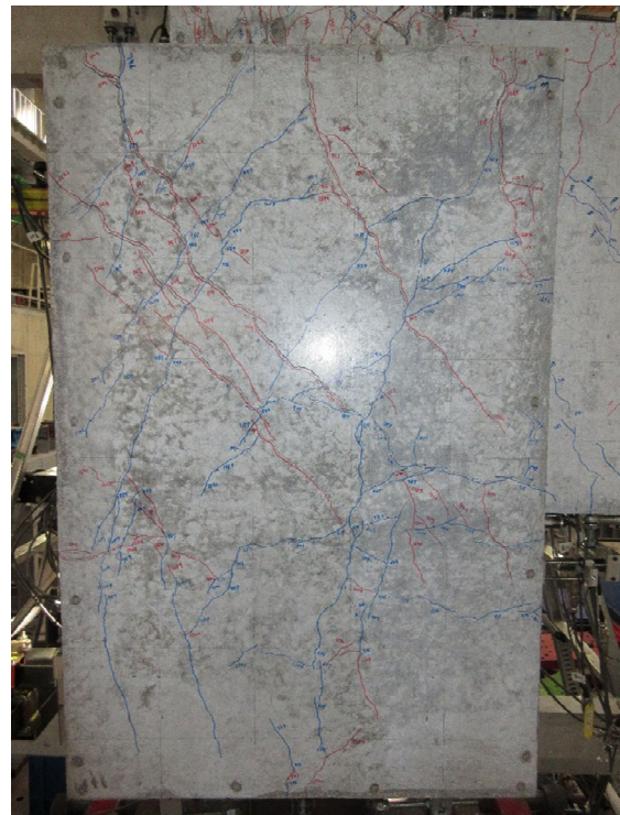
図・写真 3.1.3-12 試験体 D-3 ひび割れ状況 (10Cycle)
