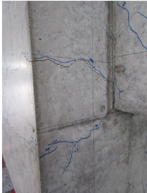
写真・図 2.1.3-11 試験体 A-7a ひび割れ状況 (6Cycle)
