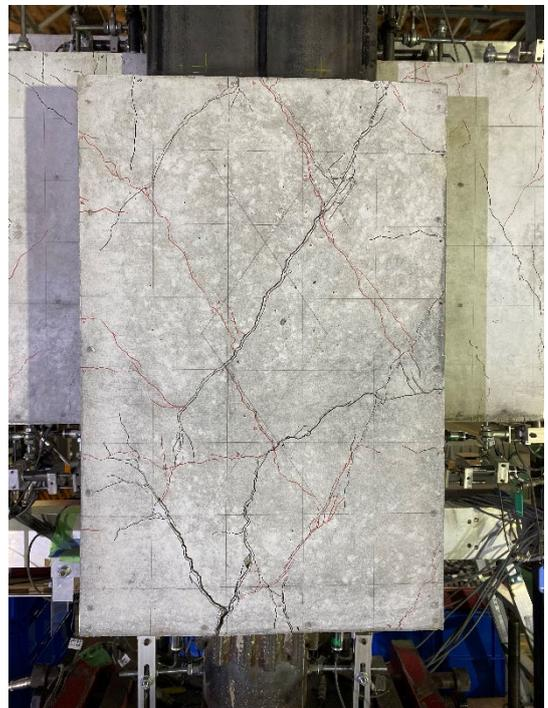
図・写真 2. 2. 3-9 試験体 F-1 ひび割れ状況 (8Cycle)
