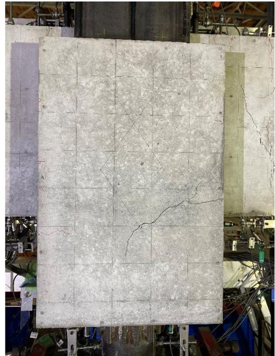
図・写真 2.2.3-4 試験体 F-1 ひび割れ状況 (3Cycle)
