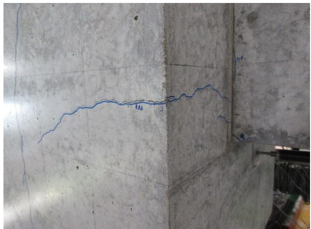
写真・図 2.1.3-40 試験体 A-9 ひび割れ状況 (4Cycle)
