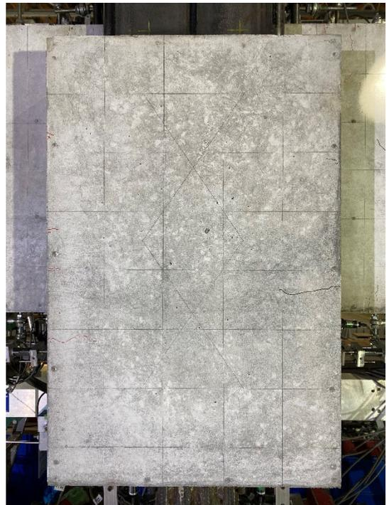
図・写真 2. 2. 3-3 試験体 F-1 ひび割れ状況 (2Cycle)
