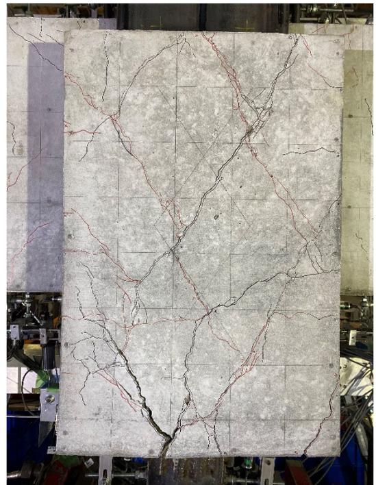
図・写真 2.2.3-11 試験体 F-1 ひび割れ状況 (10Cycle)
