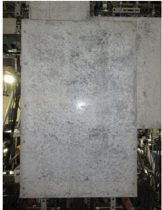
写真・図 2.1.3-49 試験体 C-4 ひび割れ状況 (30cycle)
