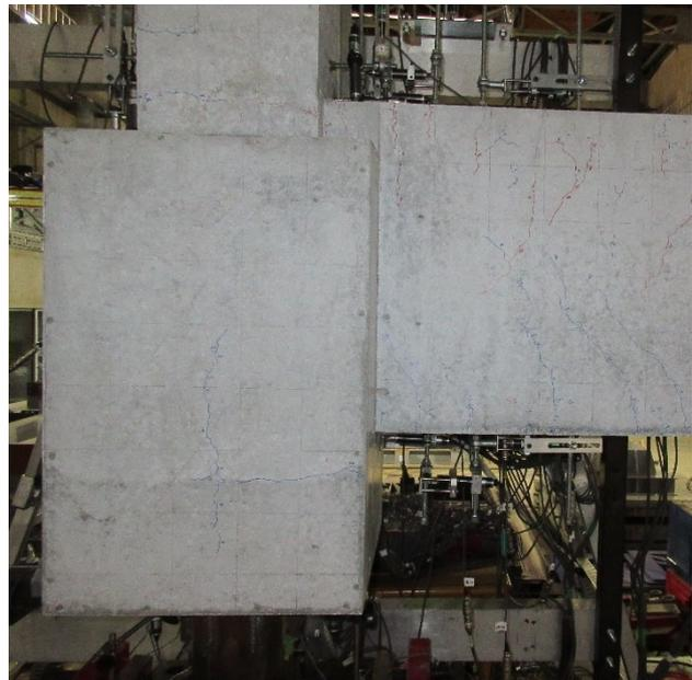
写真・図 2.1.3-9 試験体 A-7a ひび割れ状況 (4Cycle)
