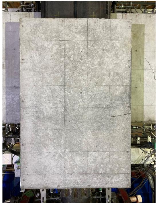
図・写真 2.2.3-2 試験体 F-1 ひび割れ状況 (1Cycle)
