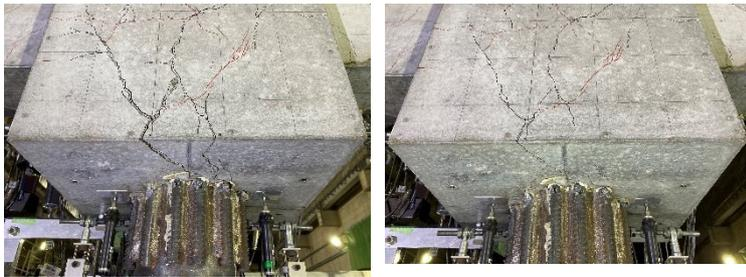
写真 2.2.4-1 最大耐力時ひび割れ状況
