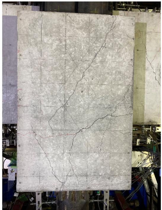
図・写真 2.2.3-6 試験体 F-1 ひび割れ状況 (5Cycle)
