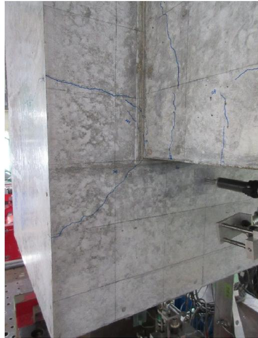
写真・図 2.1.3-29 試験体 A-8 ひび割れ状況 (4Cycle)
