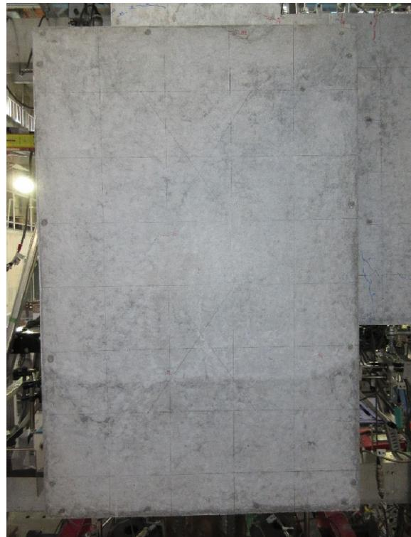
写真・図 2.1.3-7 試験体 A-7a ひび割れ状況 (2Cycle)
