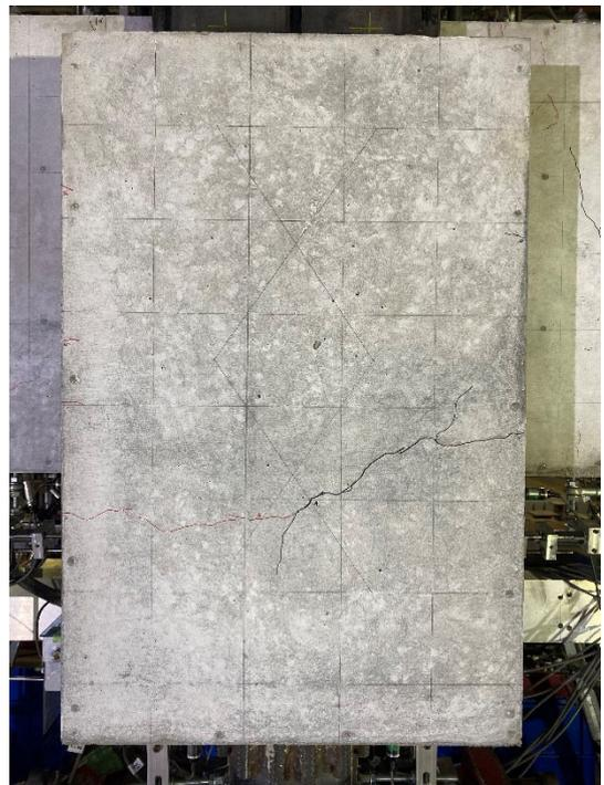
図・写真 2.2.3-5 試験体 F-1 ひび割れ状況 (4Cycle)
