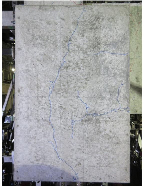
写真・図 2.1.3-51 試験体 C-4 ひび割れ状況 (5Cycle)
