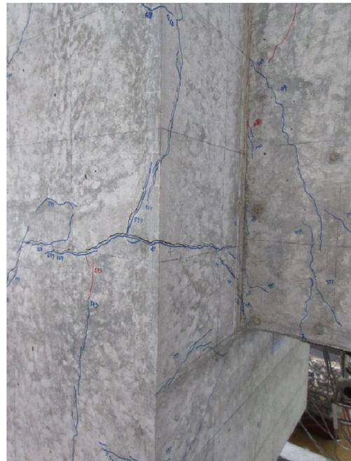
写真・図 2.1.3-31 試験体 A-8 ひび割れ状況 (6Cycle)
