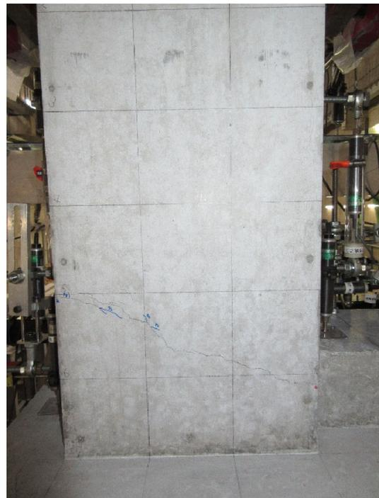
写真・図 2.1.3-17 試験体 A-7b ひび割れ状況 (2Cycle)
