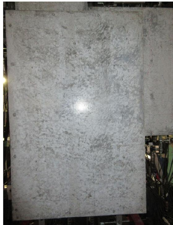
写真・図 2.1.3-48 試験体 C-4 ひび割れ状況 (20cycle)
