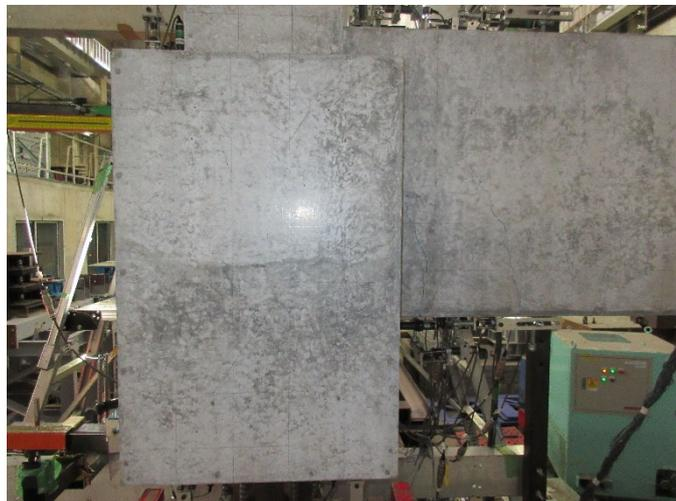
写真・図 2.1.3-26 試験体 A-8 ひび割れ状況 (1Cycle)
