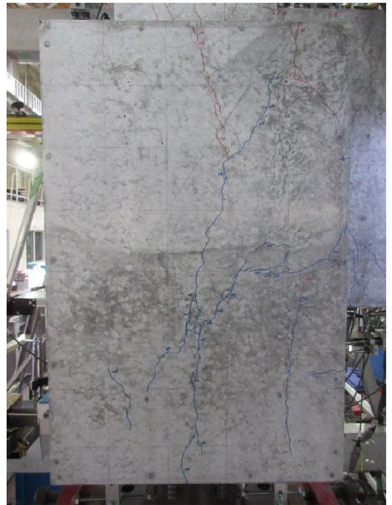
写真・図 2.1.3-30 試験体 A-8 ひび割れ状況 (5Cycle)
