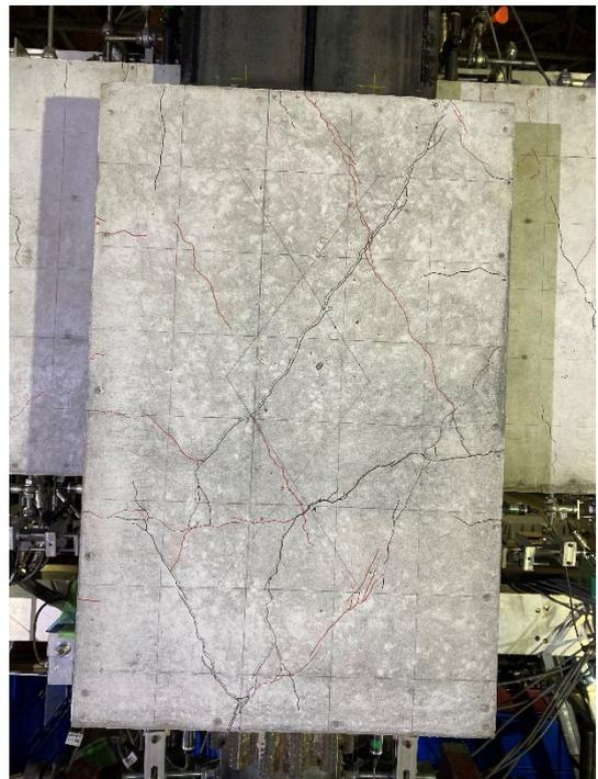
図・写真 2.2.3-7 試験体 F-1 ひび割れ状況 (6Cycle)
