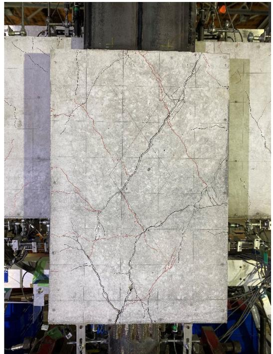
図・写真 2.2.3-8 試験体 F-1 ひび割れ状況 (7Cycle)
