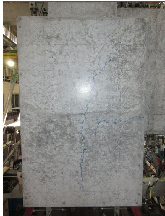
写真・図 2.1.3-28 試験体 A-8 ひび割れ状況 (3Cycle)
