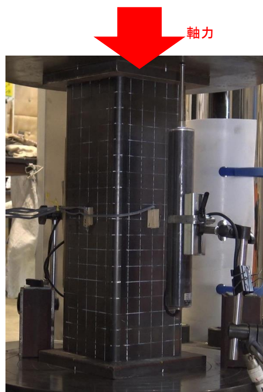
写真 3.3-1 短柱圧縮試験の状況
