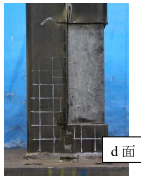
(k) d面柱脚部 内部コンクリート
