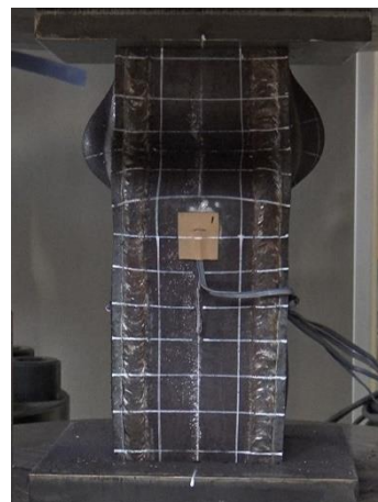
写真 2.3-2 最終破壊状況
