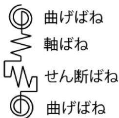
図 6.4.50 部材のばねモデル化
