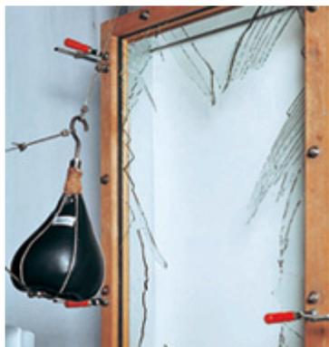
図 4-21 フロート板ガラスの割れ方
