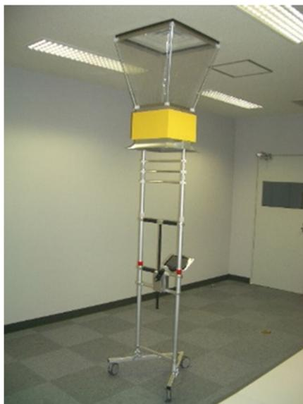
図 4-43 制気口の風量測定用機器の例
