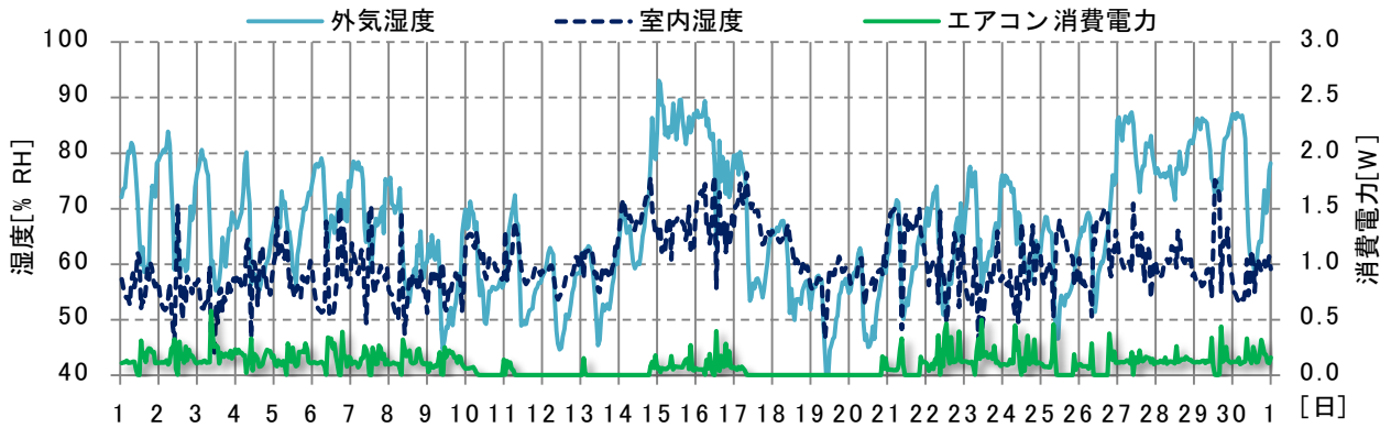
図 65 エアコン稼働状態と室内外湿度 (2015 年 9 月)
