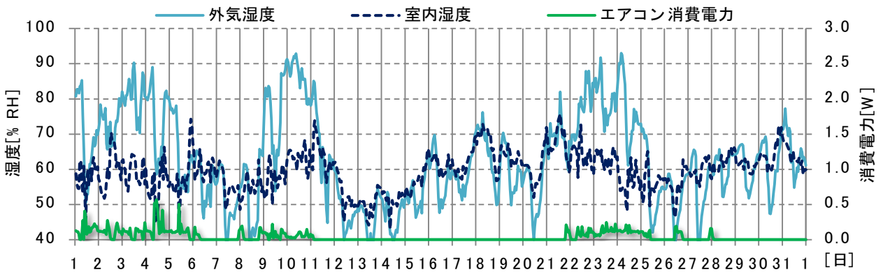
図 69 エアコン稼働状態と室内外湿度 (2015年10月)
