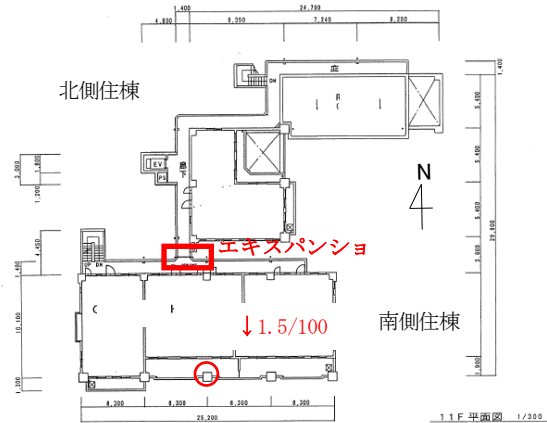
図5.5-22 傾斜の測定位置・傾斜角(11階)
