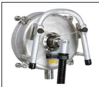
(g)集じん装置付き超高圧水洗機の例 7)
