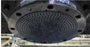
(c) すべり材下面 1セット目後
