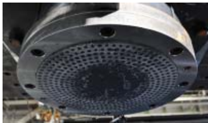
(g) すべり材下面 6セット目後
