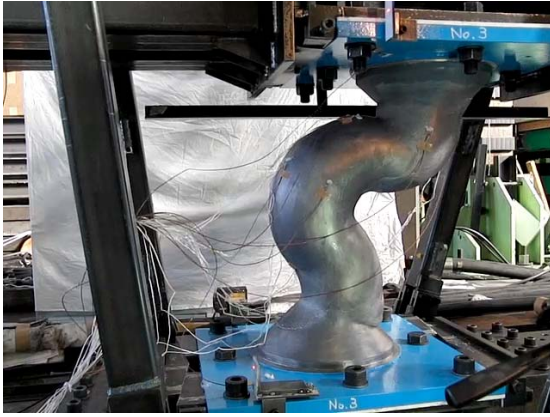
写真 3.3.4-1 地震応答波 1 波目 最大変形時
