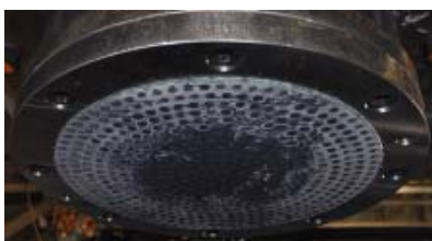
(g) すべり材下面 3セット目後
