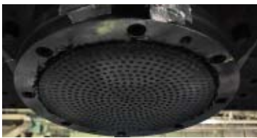
(v) すべり材下面 10セット目後
