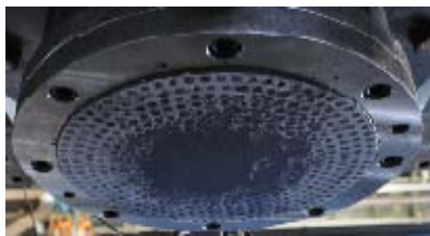
(e) すべり材下面 2セット目後
