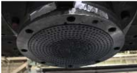
(e) すべり材下面 3セット目後
