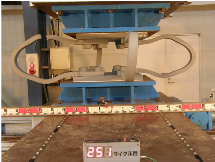
図 1.3.6-25 試験体 3 の 1 本目破断時の状況
