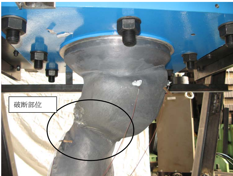
試験体 No. 1 試験後の鉛ダンパー(2)
