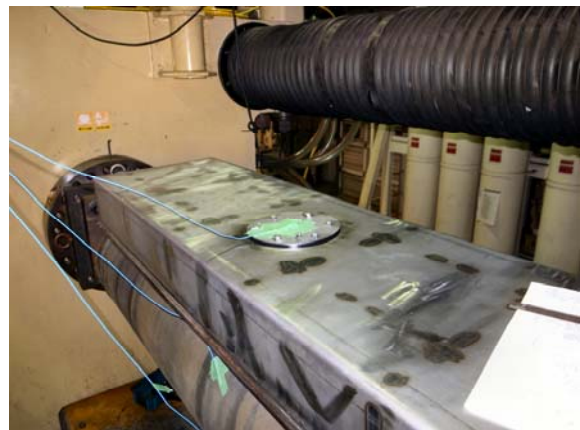
写真 1.3.8-2 油温計測用熱電対のセット状況
