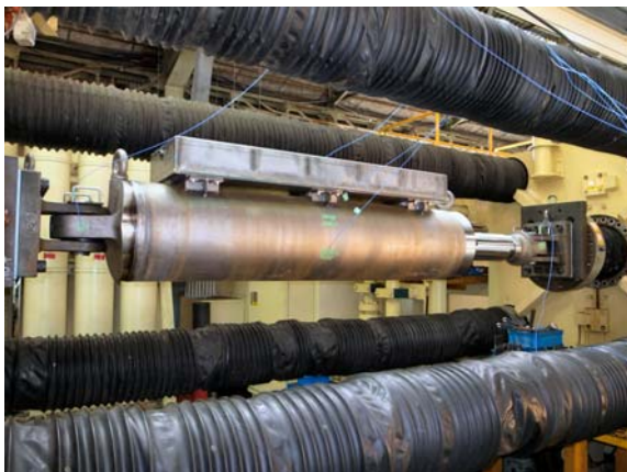
写真 1.3.8-1 熱電対のセット状況
