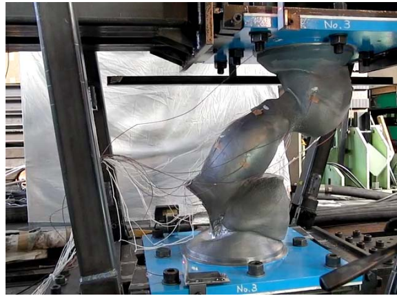
地震波 7回目 最大変形時
