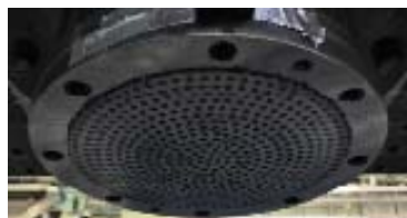
(l) すべり材下面 5セット目後
