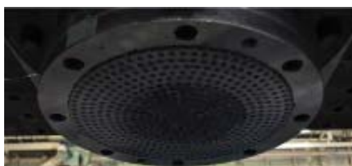
(e) すべり材下面 3セット目後
