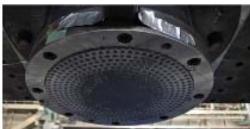
(c) すべり材下面 1セット目後
