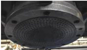
(p) すべり材下面 7セット目後
