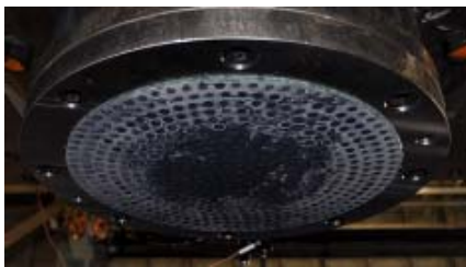
(e) すべり材下面 3セット目後
