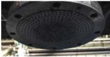
(e) すべり材下面 2セット目後
