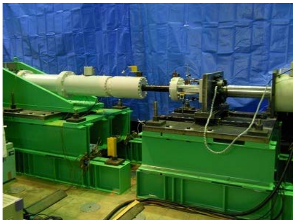
写真 1.3.9-5 RDT30 試験体取り付け状況
