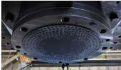
(c) すべり材下面 1セット目後
