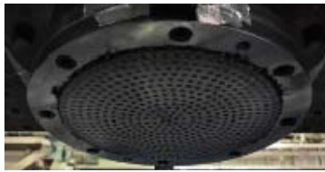
(t) すべり材下面 9セット目後
