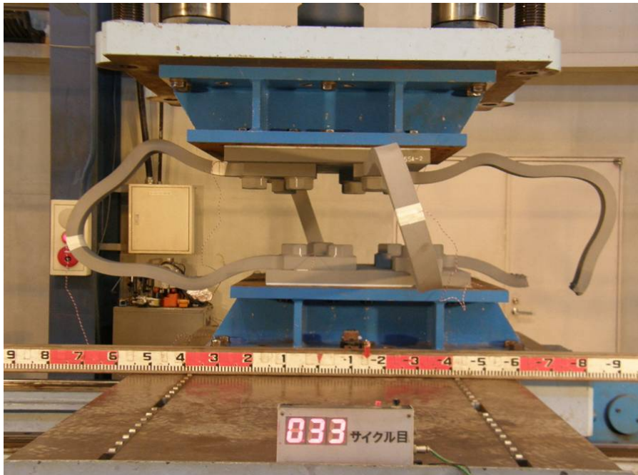
図 1.3.6-24 試験体 2 の 1 本目破断時の状況
