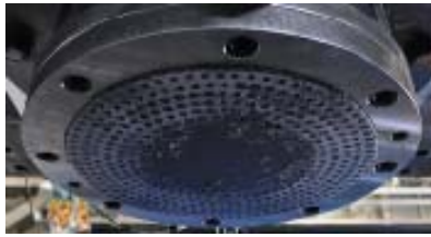
(l) すべり材下面 5セット目後
