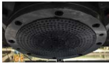
(t) すべり材下面 9セット目後
