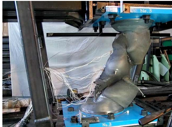
地震波 12回目 最大変形時
