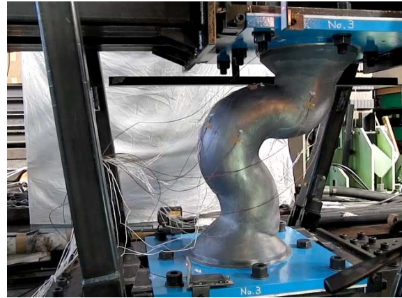
地震波 1 回目 最大変形時
