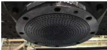
(g) すべり材下面 6セット目後
