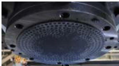
(c) すべり材下面 1セット目後
