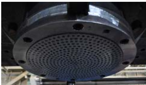
(c) すべり材下面 10セット目後
