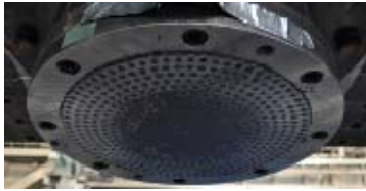
(c) すべり材下面 1セット目後
