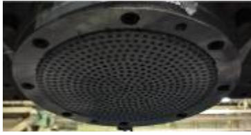
(n) すべり材下面 6セット目後
