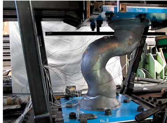
地震波 2 回目 最大変形時
