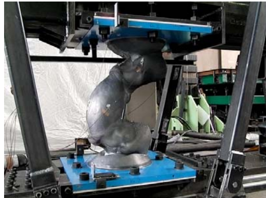
100 サイクル (2 回目試験累積変形 60m)
