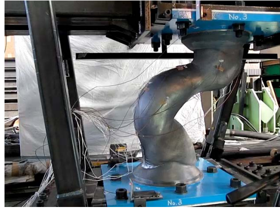
写真 3.3.4-2 地震応答波 3 波目 最大変形時
