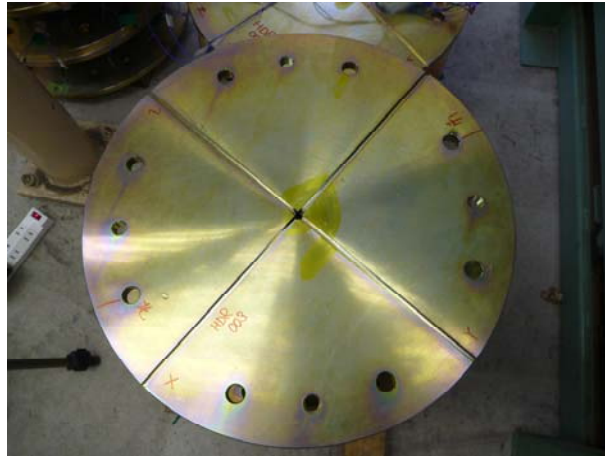
(a) 熱電対配線用のフランジ溝
