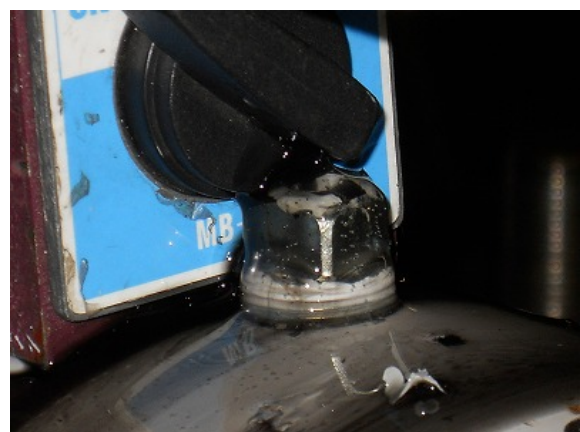
写真 1.3.9-8 RDT8 試験体のセンサー取付用キャップの状況
