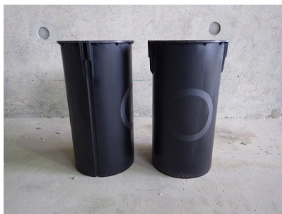
管理用供試体に用いた軽量型枠の外観
