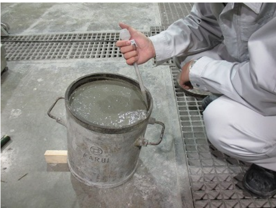
ブリーディング試験の状況
