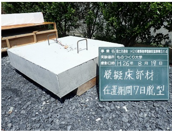
模擬床部材の型枠の脱型
