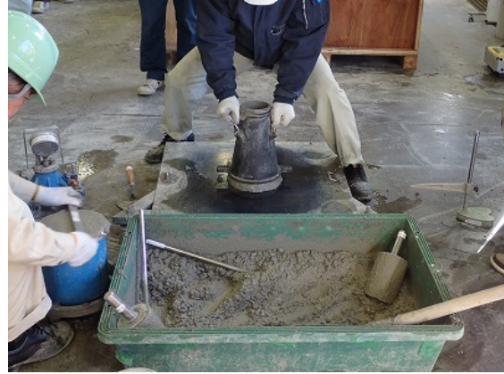
スランプまたはスランプフロー試験の状況
