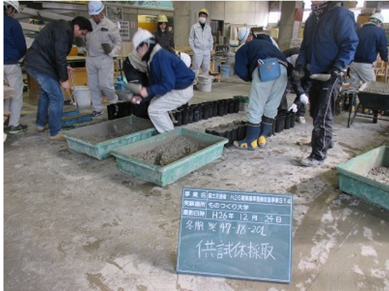
管理用供試体の打込みの状況
