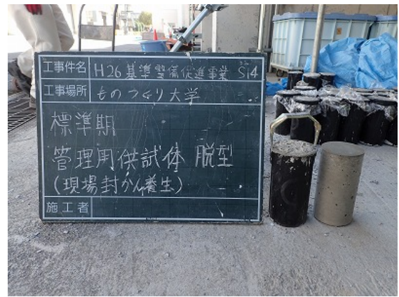
管理用供試体の型枠の脱型
