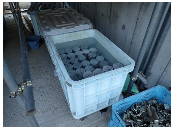
現場水中養生の状況
