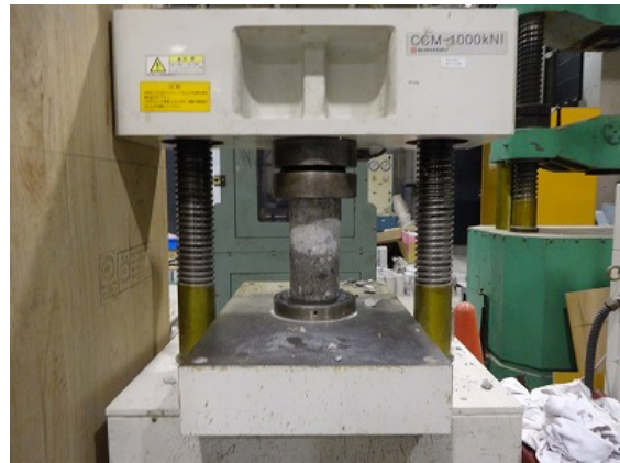
圧縮強度試験の状況
