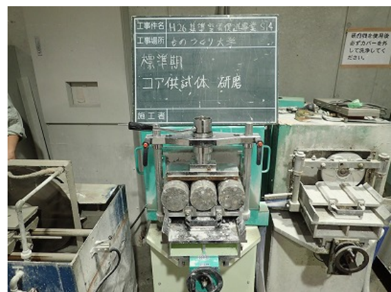
コア供試体および管理用供試体の端面の研磨による仕上げ状況
