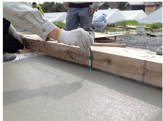
模擬床部材の熱電対の取付け状況
