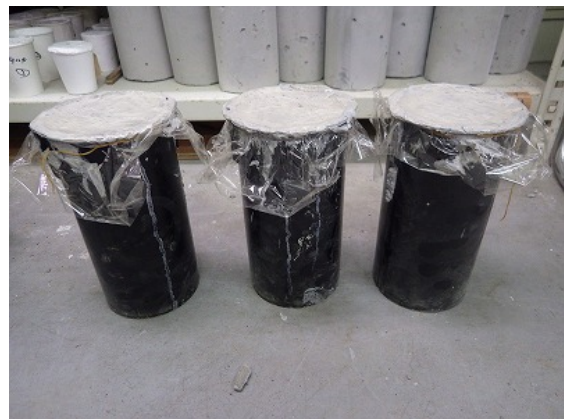
標準養生供試体の気中養生の状況
