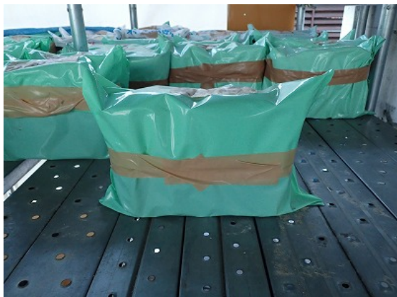
現場封かん養生の状況
