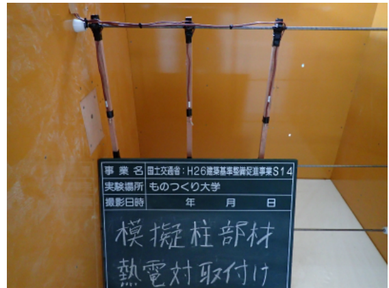
模擬柱部材の熱電対の取付け状況
