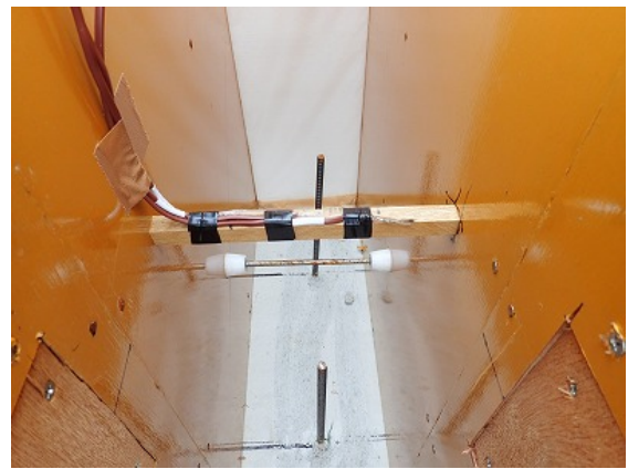
模擬壁部材の熱電対の取付け状況
