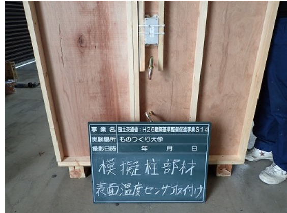
模擬柱部材の表面温度センサの取付け状況
